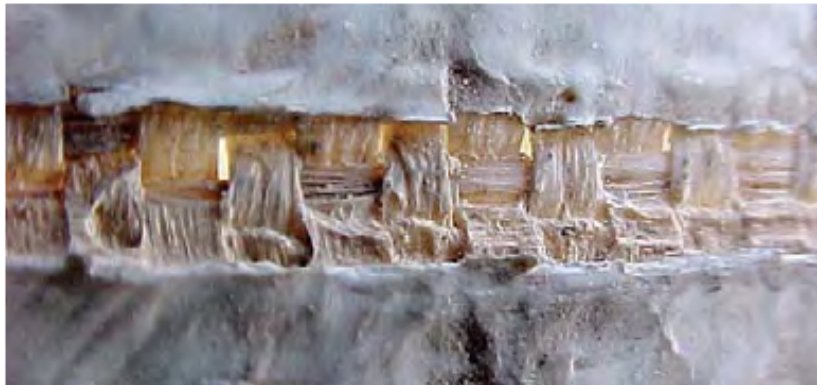
Figura 3 Vista de la fibra de poliéster dentro de una lámina de PVC rota
